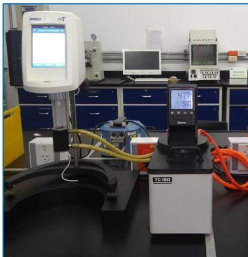
Figura 2. Viscosímetro rotacional Brookfield DV2TLV
