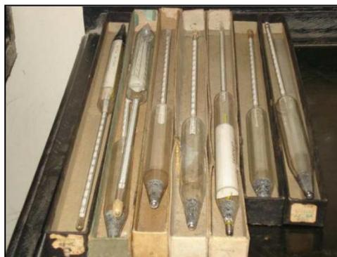
Figura 3. Hidrómetro
