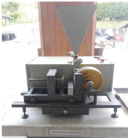
Figura 7. Equipo de ensayo de abrasión UPB.
