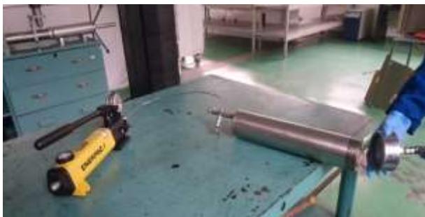
Figura 4. Saturación con agua de formación, plug arena M-2, VHR-13 Fuente: Laboratorio CIQ Petroecuador EP, 2019.
