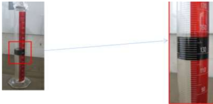
Figura 7. Fluido obtenido, desplazamiento con agua de formación y solvente Fuente: Laboratorio CIQ Petroecuador EP, 2020
