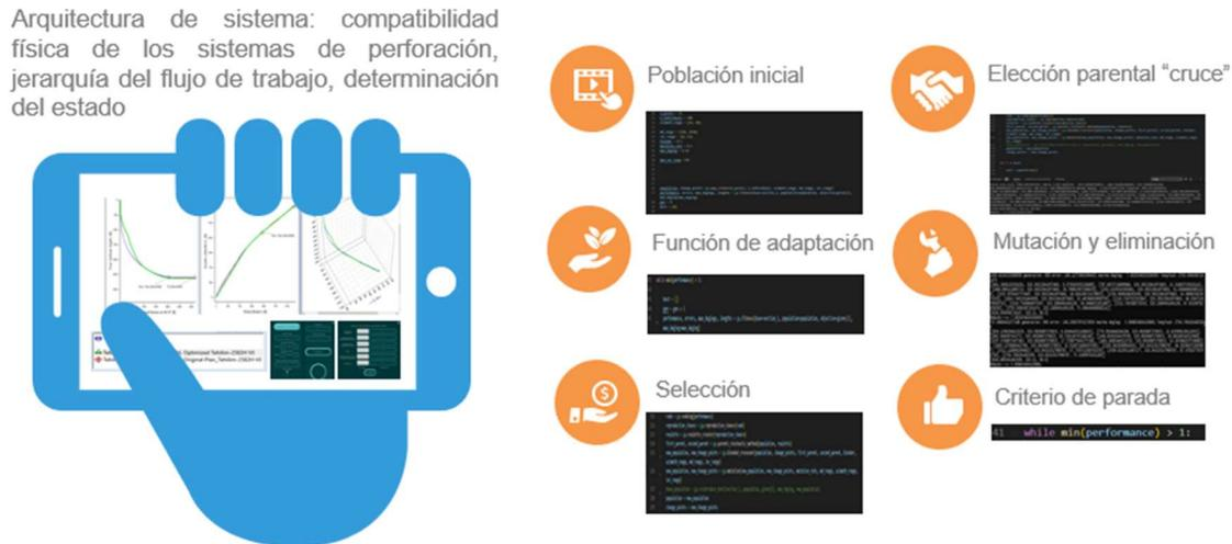
**Figura 6.** Las principales partes de la aplicación de código fuente del algoritmo de optimización genética diseñado para automatizar el proceso de diseño de trayectorias de pozos horizontales
