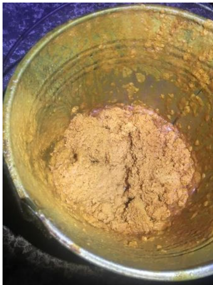
Figura 9. Evidencia de crudo congelado por bajas temperaturas después del choque.
