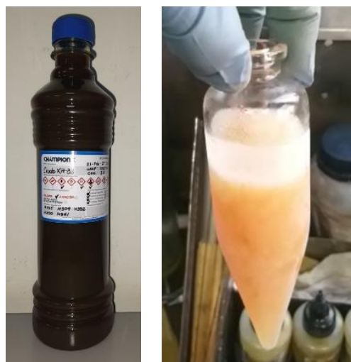
Figura 10. Cambio de propiedades del crudo a). API inicial 46.8°; b) condición estabilizada API 59.9°
