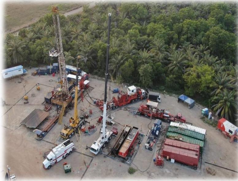
**Figura 4.** Unidad de wire line, Coiled tubing y equipo de workover.
