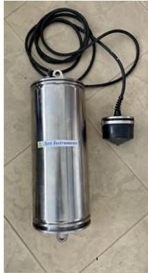
Ilustración 1. Grabadora de datos con hidrófono intercambiable.
