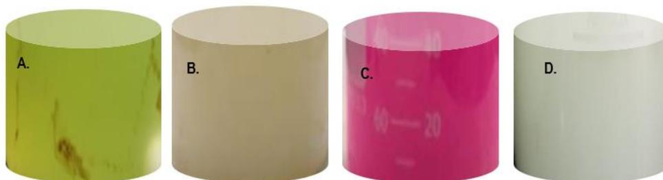
**Figura 1.** Fotografía de los cuatro nanofluidos A) ND1 basada en CQD Verde, B) ND2 basado en CQD azul 1, C) ND3 basado en CQD azul 1 y D) ND4 basado en CQD azul 2 sintetizados para inclusión en fluidos de perforación para detección de zonas fracturadas.
