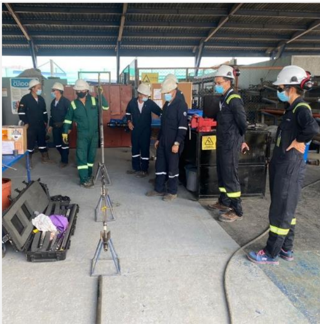
Figura 3: Armado de BHA Barracuda™ HEX-Hanger™ y Sensores
