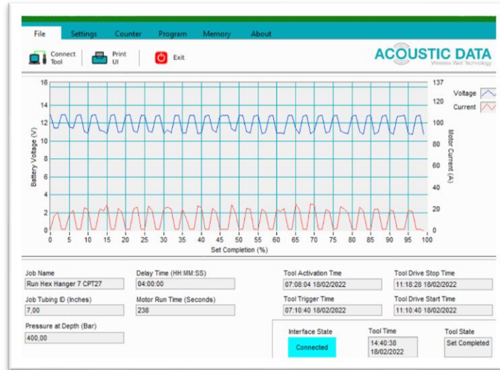
Figura 4: Evidencia Comprobación asentamiento correcto Barracuda™ HEX-Hanger™
