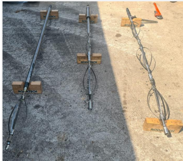
Figura 6: Componentes BHA Barracuda™ HEX-Hanger™ Recuperado
