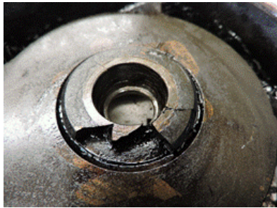
Ilustración 8. Buje de WC roto en el caso 2.
