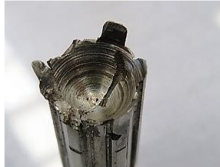
Ilustración 5. Vista frontal del eje roto en el caso 1.
