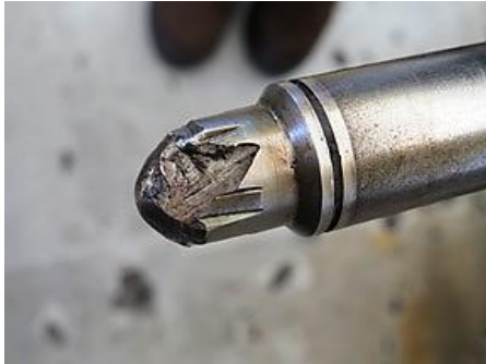
Ilustración 4. Vista lateral del eje roto en el caso 1.
