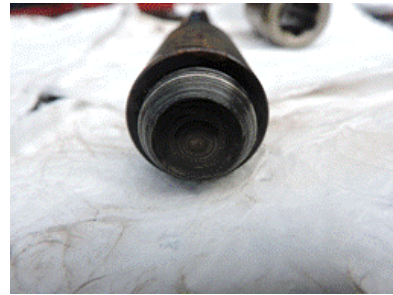
Ilustración 9. Vista del eje roto en el caso 2.
