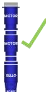
Instalación del tándem de motores para el Sistema ESP Invertido
