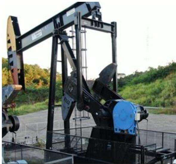
**Figura 9. Unidad de Bombeo Mecánico con PMM – Instalación LCI**
