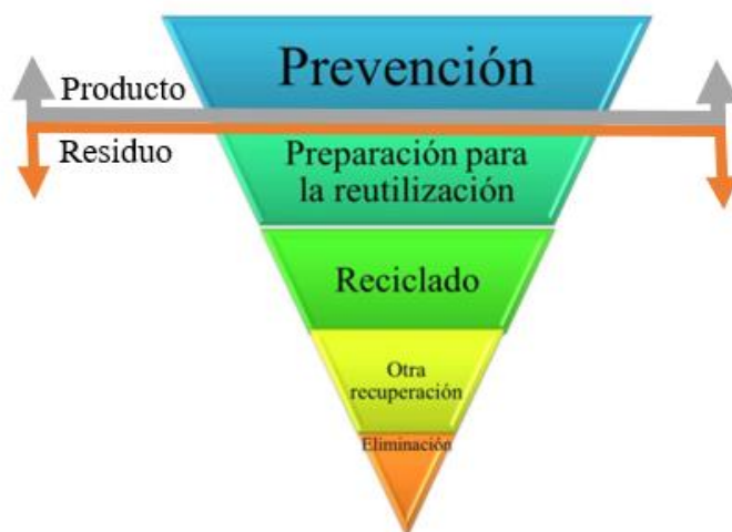
Diagrama 1. Jerarquía de los residuos según la Unión Europea. Adaptado de la Comisión Europea [1].
