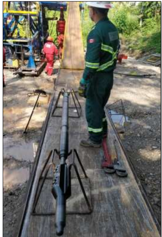
Figura 15. BHA definido para el poncheo a realizar en el pozo.
