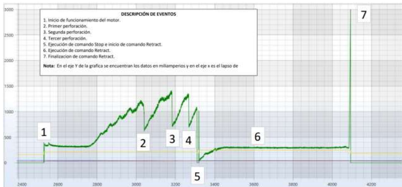
Figura 17. Registro del módulo electrónico (PCM) después de la segunda corrida
