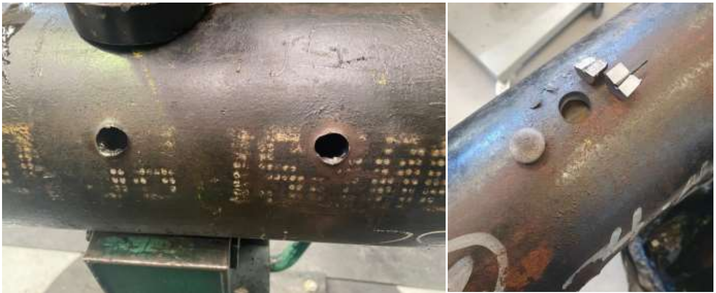
Figura 2. Muestra de Casing Ponchado
